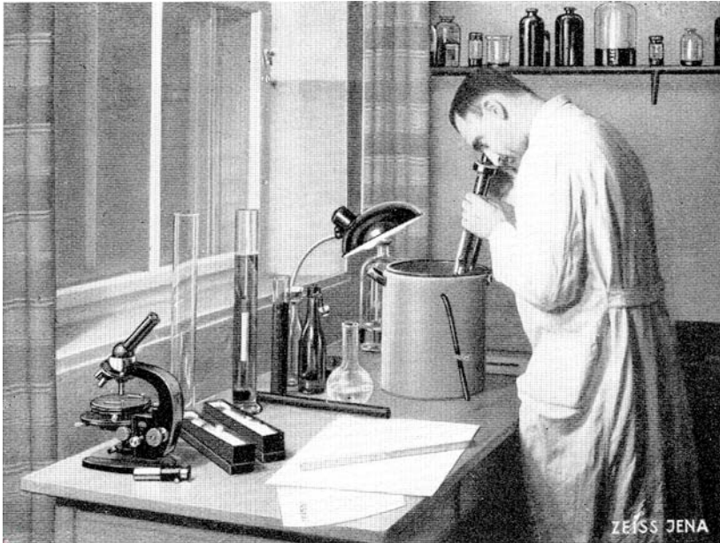
Das refraktometrische Verfahren in Anwendung in einem Brauereilaboratorium
