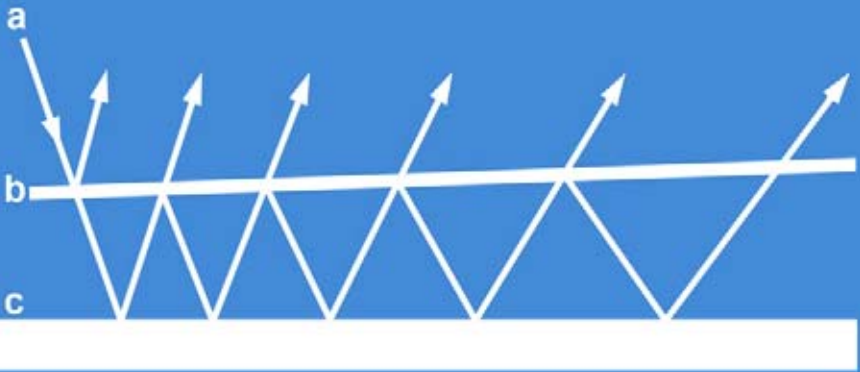
Bild 2. Entstehung der Mehrfachreflexion a = einfallender Lichtstrahl b = teildurchlässige Reflexionsschicht c = Oberfläche des Prüflings
