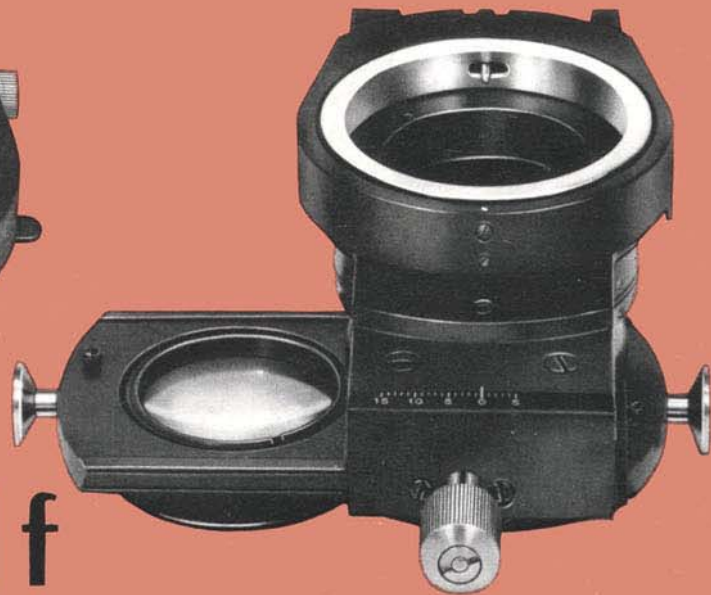
Kondensorenhänger nd mit schiebbarer Großfeldlinse
