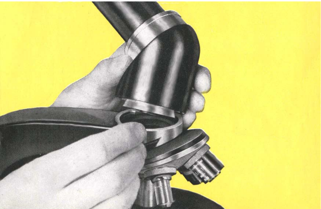
Bild 18 • Benutzung des Tubusschnellwechslers
