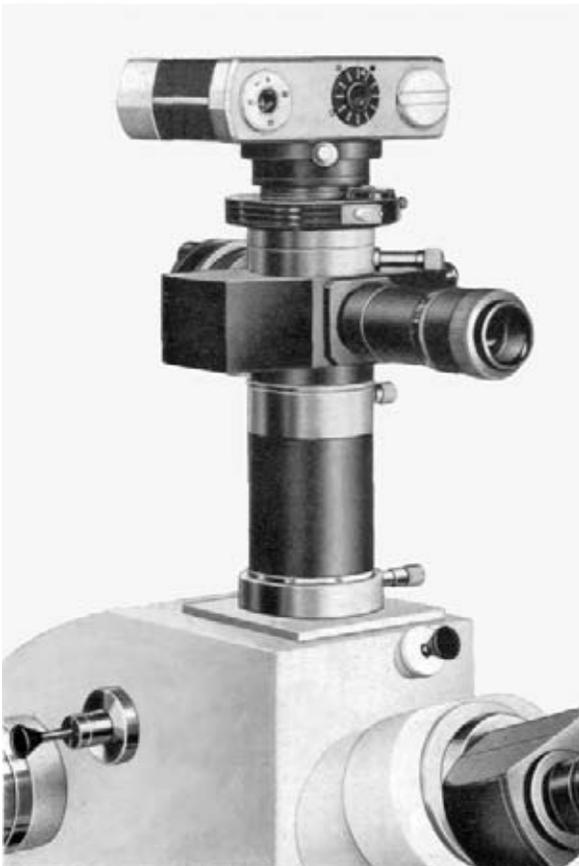
Die besondere optische und mechanische Konstruktion des Universal-Forschungsmikroskops NU 2 ermöglicht eine rationelle **Mikrofotografie** vom Kleinbildformat bis zum Format 9 cm x 12 cm. Bei Verwendung des pankratischen Okulars wird der Kameraansatz direkt auf den oberen Ausgang des Mikroskops aufgesetzt. Ein hinter dem pankratischen Okular eingebautes Projektiv bildet das Objekt scharf auf der Negativebene ab, der Abbildungsmaßstab kann dabei wieder kontinuierlich verändert werden.
