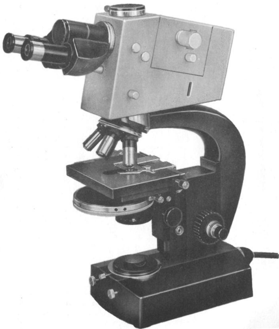
Bild 1 Interphakomikroskop Nf für Durchlicht
