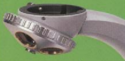
Tubuskopf Standard 16 mit fest angeschlossenem 5-fach Objektivrevolver.
