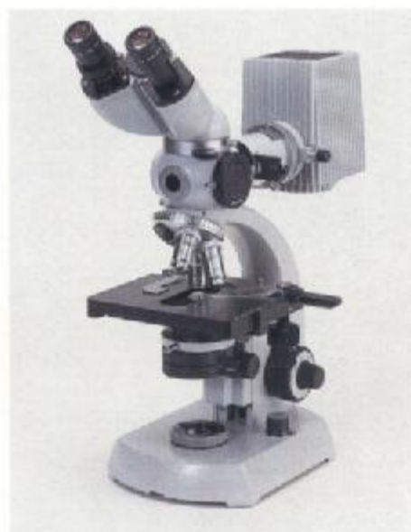
Mikroskop Standard 16 Auflicht-Fluoreszenz kombiniert mit Durchlicht-Phasenkontrast für immunologische Untersuchungen 49 11 43
