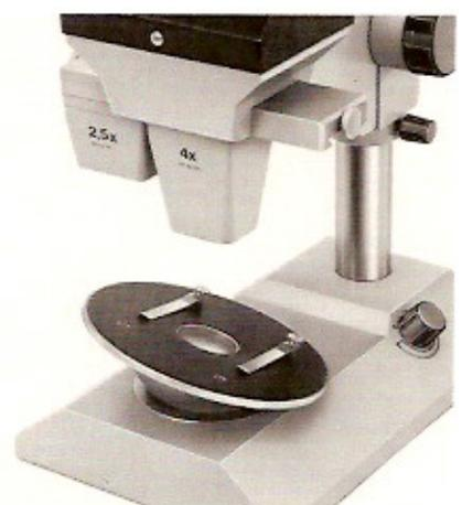
Runde Tischplatte mit 135 mm  $\phi$ , mit Kugelkalotte; diese wird in die Öffnung des Fußes der Stative L und LO gestellt. Objekte können bis ca. 25° aus der Horizontalen geschwenkt und beliebig um die vertikale Achse gedreht werden. Für Aufflicht und Durchlicht.
